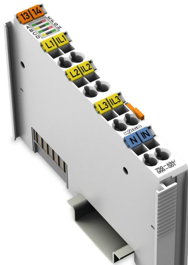
El nuevo módulo 750-494 mide corrientes DC y AC de hasta 20.000A
